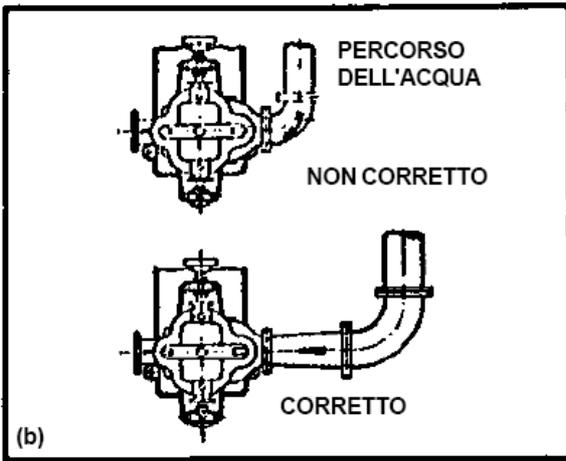
Vanno assolutamente evitate le curve in aspirazione, poiché queste creano differenti velocità di ingresso in aspirazione della pompa, dando luogo a disturbi del flusso dannosi, proprio in corrispondenza alla girante della pompa.
