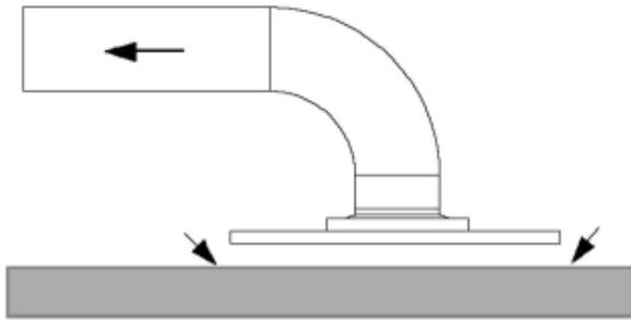
pavimento della riserva idrica, **qualche centimetro**, favorisce appunto, la riduzione della velocità e della turbolenza in aspirazione.
