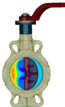
tema di problemi che si possono verificare nella condotta aspirazione, va evidenziato che l'uso di valvole a farfalla, evitare, poiché queste riducono la sezione di passaggio (a sezione ovviamente). La cosa peggiore però è nella loro caratteristica di spezzare il flusso, favorendo proprio turbolenze tanto dannose, soprattutto nelle vicinanze dell'aspirazione delle pompe.
